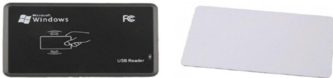
Gambar 2. Usb RFID Reader 125khz dan RFID tag
